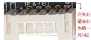
1：此默认配置为使用共阴极 LED 灯，如使用的为共阳极灯时，可在制作外接延长线时，将 LED 灯的共同脚接到第 3PIN 上面作为电源输入，注意，此接法后，灯的状态会变，需要软件配置更新。
